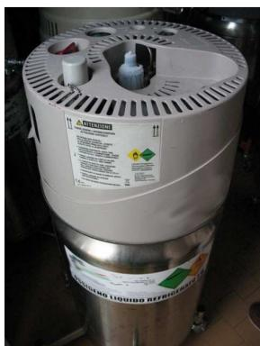
In queste condizioni viene ridotto al minimo lo scambio di calore per conduzione fra il contenitore interno e quello esterno.
