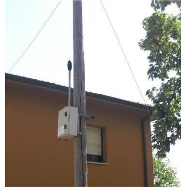
Le stazioni sono complete di cavalletti e supporti per collocare i microfoni fino ad un'altezza di 6 metri e di 4 box cabinet impermeabili per il fissaggio della strumentazione ai pali per l'illuminamento o simili, posti lungo gli assi stradali. In particolare uno dei quattro box è provvisto di una connessione con il sistema di alimentazione elettrica di rete per consentire monitoraggi di lunga durata (oltre le 48 ore).
